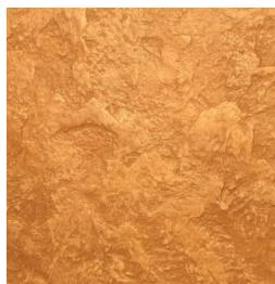
Готовый к применению экологически чистый и паропроницаемый отделочный материал для выполнения декоративной отделки. Обладает оригинальной фактурой, очень точно передающей эффект грубого, рельефного необработанного камня. Штукатурка образует прочное и долговечное покрытие, способное перекрывать мелкие трещины, и эффективно применяется для изысканной отделки стен с различной эксплуатационной нагрузкой.
